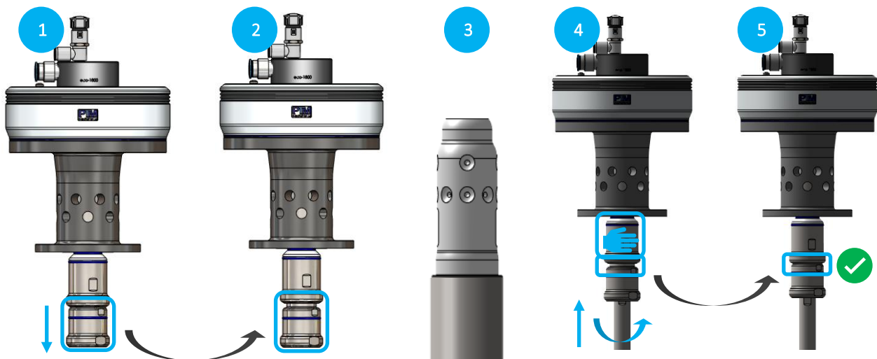
Abbildung 2: Rührwellenmontage mit eco-Quick V3 bzw. eco-Quick V4
