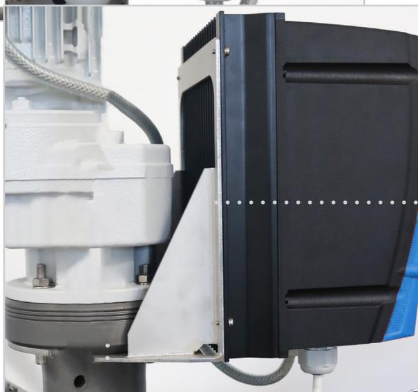
Motorwinkel bzw. Motorplatte
